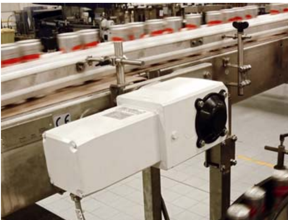
Der von Baumüller und ZAE Antriebssysteme entwickelte Getriebemotor erreicht einen Wirkungsgrad von 85 bis 90 %. Bei Antrieben mit Asynchronmotor liegt dieser Wert bei maximal 70 %.
